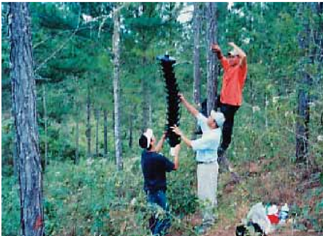
Figura 1: Establecimiento de la trampa tipo Lindgren, entre árboles de pino, durante el periodo en que se realizó el monitoreo.
