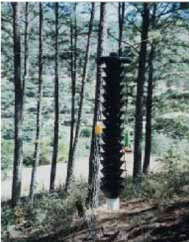
Figura 2: Trampa del tipo Lindgren non-sticky funnel trap de doce embudos, utilizada para la captura de descortezadores durante la realización del estudio.
